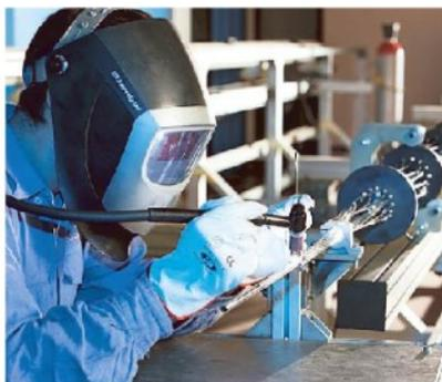
Il processo di saldatura del filo superconduttivo
